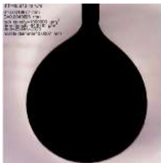
شکل ۱: تصویر قطره نفت خام و عدد گزارش شده ی کشش بین سطحی آن
