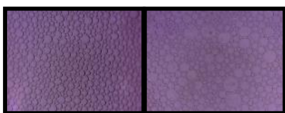
شکل ۴- تصاویر میکروسکوپی در تست بالک (سمت راست در شوری بالا، سمت چپ در شوری پایین)
